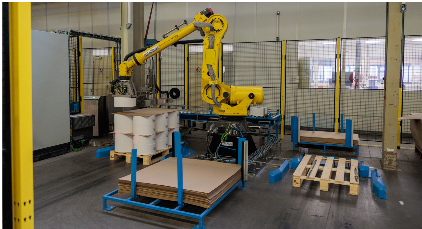
De palletiseerrobot krijgt 12 seconden om rol op de juiste positie te plaatsen. Dat is gelukt door het plaatsen van een nieuwe pallet en het bepalen van de oriëntatie van de rol niet meer door de robot te laten doen.
