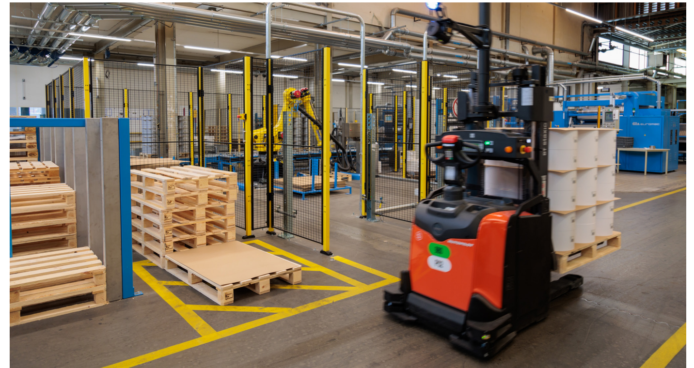
Het transport tussen de drie palletiseercellen en de palletverpakingsstraat wordt verzorgd door in totaal drie AGV's. De AGV legt ook een nieuwe pallet neer bij de robots.
