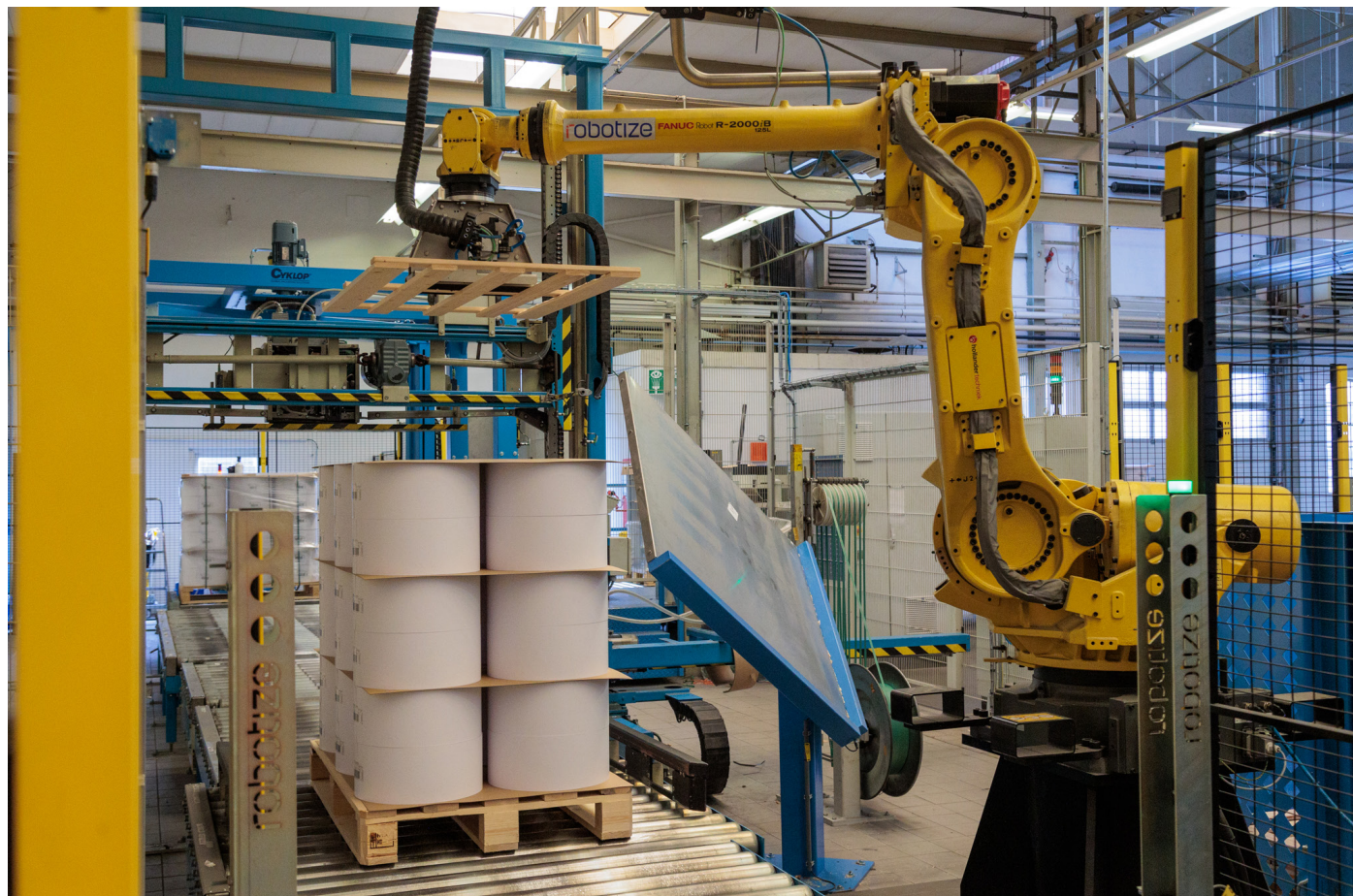
Optimaal hergebruik: de robot die het deksel op een pallet met rollen legt komt van elders uit de productie.
