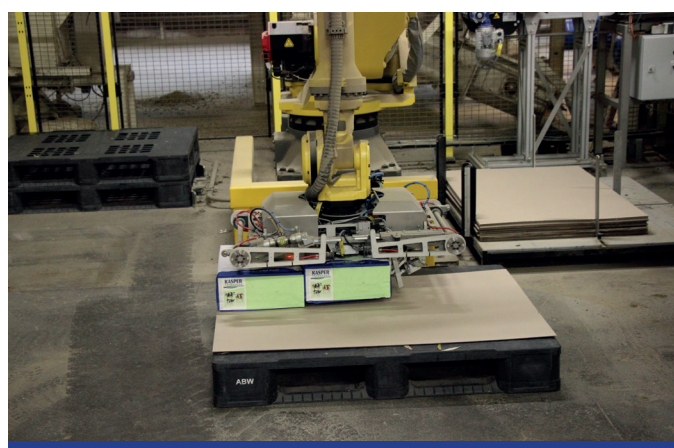
De universele grijper kan overweg met pallets, tussenlegvellen en uiteraard alle verschillende zakken met koek die van de verpakkinglijn komen.
